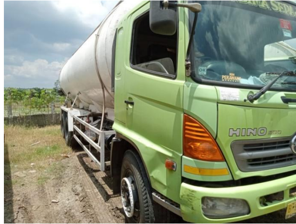
Gambar 1. Mobil truk jenis tangki (semen curah) Muatan kurang lebih 30 ton Sumber: PT. Bima Sepaja Abadi
