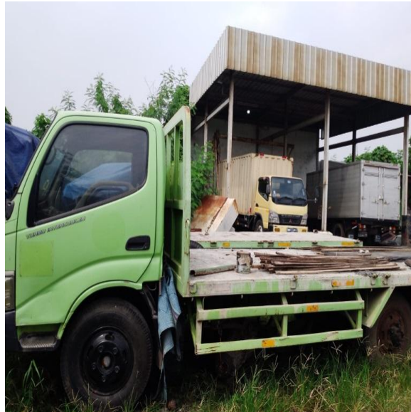
Gambar 3. Truk jenis CDD losbak Muatan +/- 10 ton Sumber: PT. Bima Sepaja Abadi
